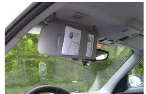
Unter der Fahrersonnenblende fixiert ist die Rettungskarte für die Feuerwehr stets griffbereit.
